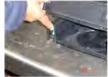
En la tapa posterior plástica de la máquina encontrará un círculo atravesado por una ranura como se señala, este círculo es la tapa protectora de un botón. NO intentar quitar los tapones ubicados en la parte baja metálica (Ubicados entre conector de agua y cable)
