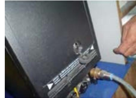
Pulse firmemente el botón hasta sentir la activación del botón. Al terminar la actividad y comprobar que la máquina está operando vuelva a cerrar la tapa girando ahora en sentido contrario. Una vez terminado este procedimiento esperar 20 minutos para que el agua alcance su temperatura
